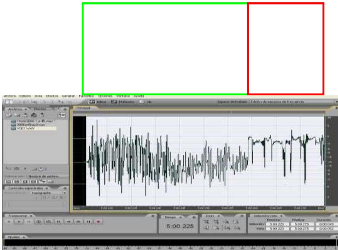
Este gráfico ilustra la onda secundaria, donde no se observa saturación pues es originada por el proyectil (recuadro de color verde). En cambio, la onda primaria originada en el proceso deflagratorio de empuje del proyectil en el arma genera saturación, pues el micrófono o receptor se encuentra muy próximo al origen o foco sonoro.
