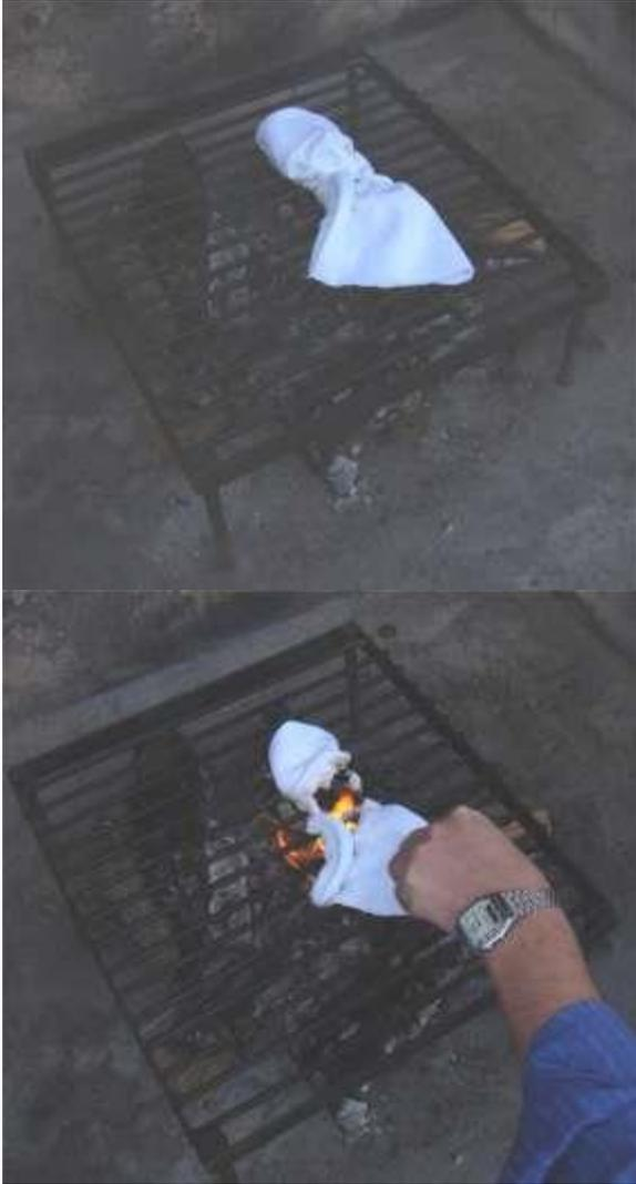
La imagen izquierda ilustra el momento cuando se colocó la porción de la muestra sobre la parrilla. Obsérvese que no hay flama, pero al momento del derretimiento de las fibras las que se precipitan generan la ignición.
