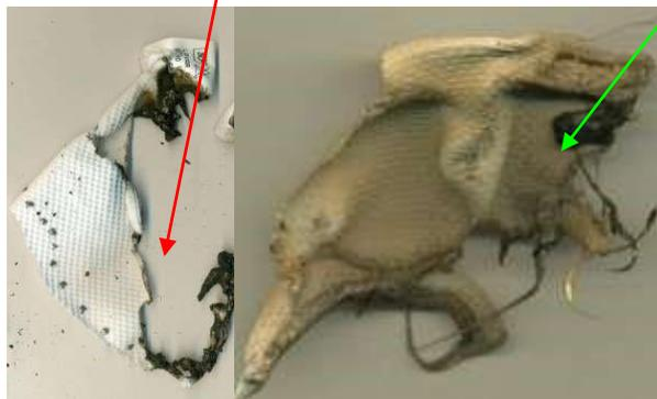
Con flecha de color verde se colocó la prenda en una parrilla con llama directa. El entintado por el humo torna a los restos no quemados de un color ocre muy característico. El inicio de la ignición comienza a los 7 segundos, expuesto a la temperatura de flama de leña.
