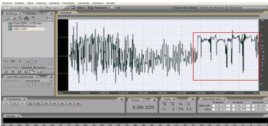
El recuadro de color rojo señala la onda primaria, las mesetas indican saturación del mecanismo de registro.
