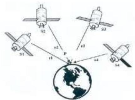
El segmento espacial contiene los satélites emisores de las señales, conocidos como Constelación Navstar (Navigation Satellite Timing And Ranging), que consta de un mínimo de 24 satélites dispuestos en 6 planos orbitales, con 55° de inclinación con respecto al Ecuador. Dispone además de algunos satélites de recambio, por si alguno de los que están en funcionamiento fallasen.
