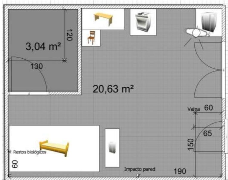
En este sistema se utilizarán dos cintas métricas. Una de ellas se colocará en el borde o en el centro de la habitación y se dejará fija. Con la otra cinta métrica se bajarán las perpendiculares a la anterior y se leerán sobre ambas las medidas que marcan en el punto de intersección.
